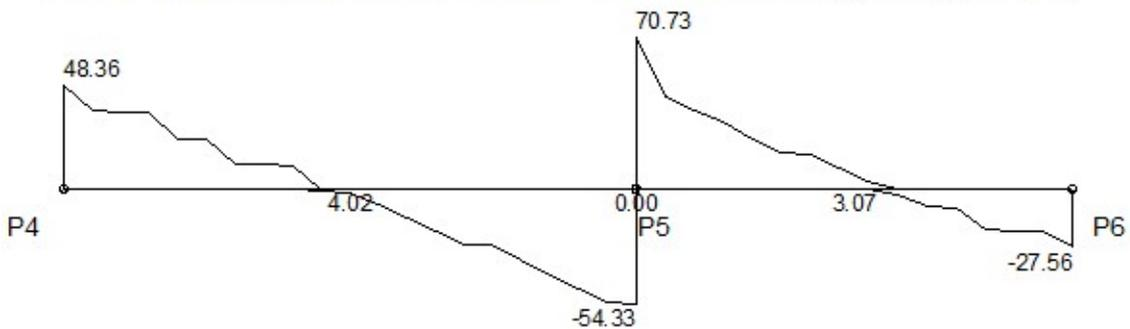
Figura 6 – Momento fletor (kNm) e esforço cortante (kN) viga V2 – Eberick.
