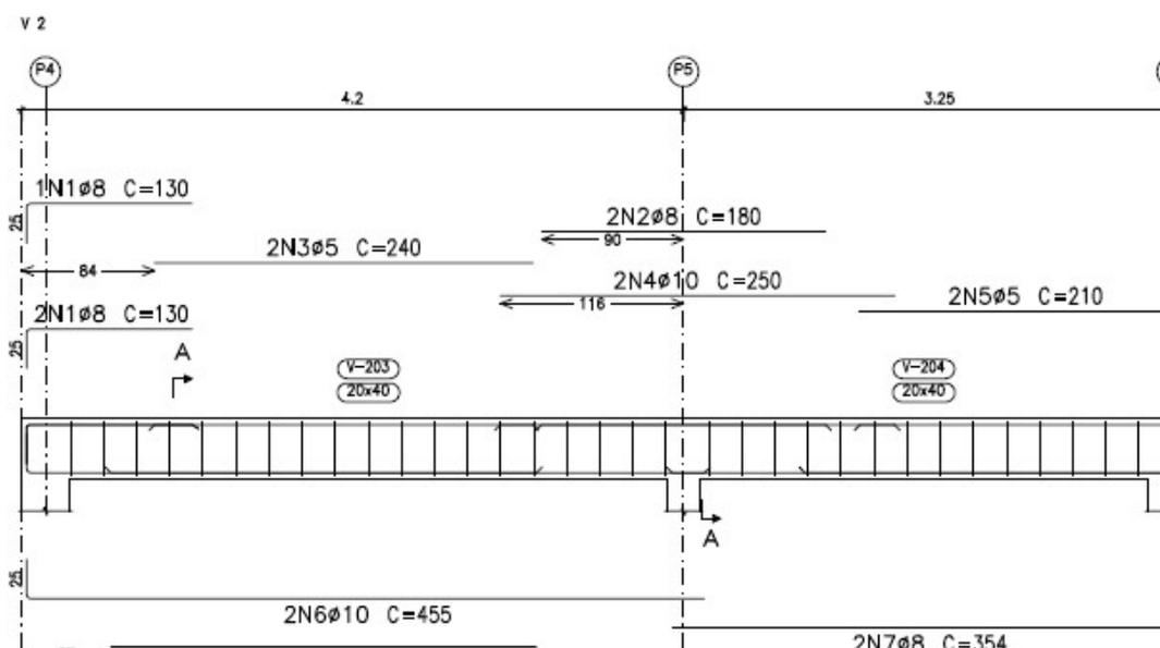
Figura 7 – Detalhamento viga V2 – Cypecad.
