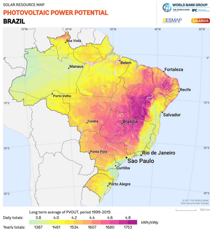
Figura 01 - Mapa de potencial fotovoltaico no Brasil. Fonte: Solar Finger. Disponível em < https://globalsolaratlas.info/ > 20:06
