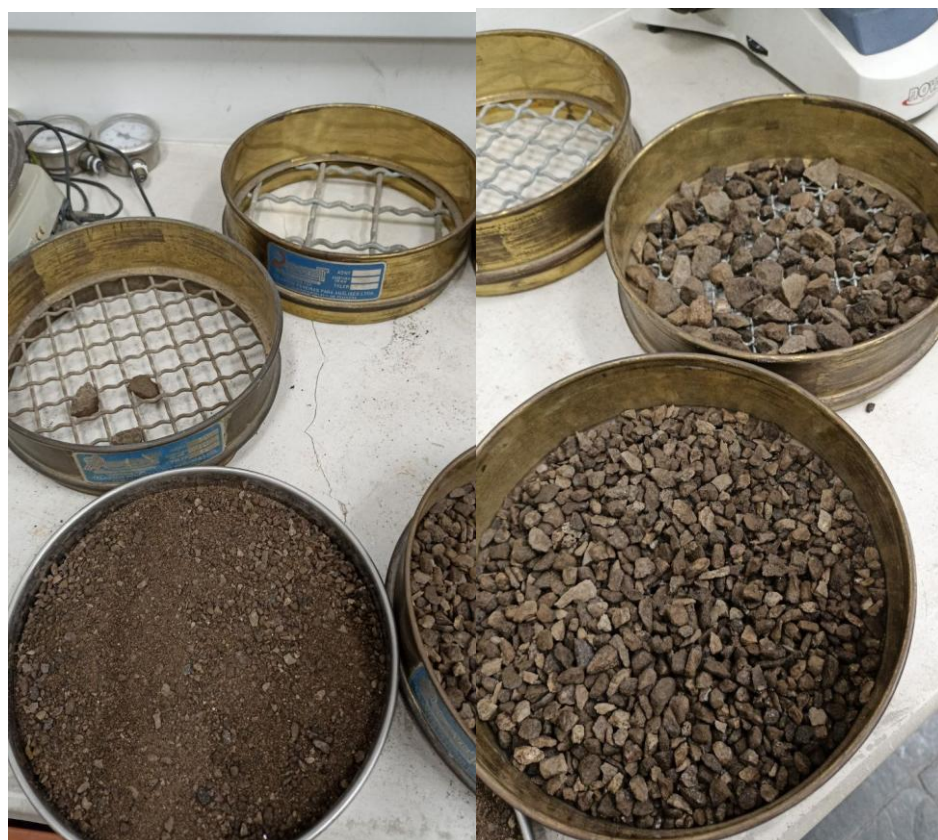
Figuras 7 e 8: Ensaio de granulometria total após secagem.
