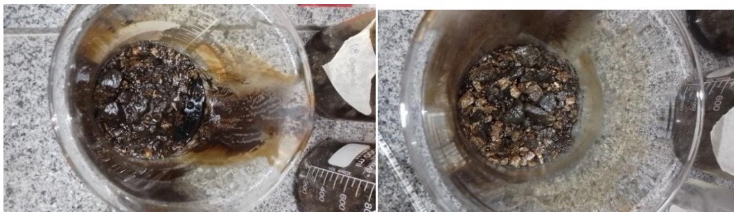
Figuras 5 e 6: Agregados de Guaratiba Graúdo e Miúdo pós lavagem.
