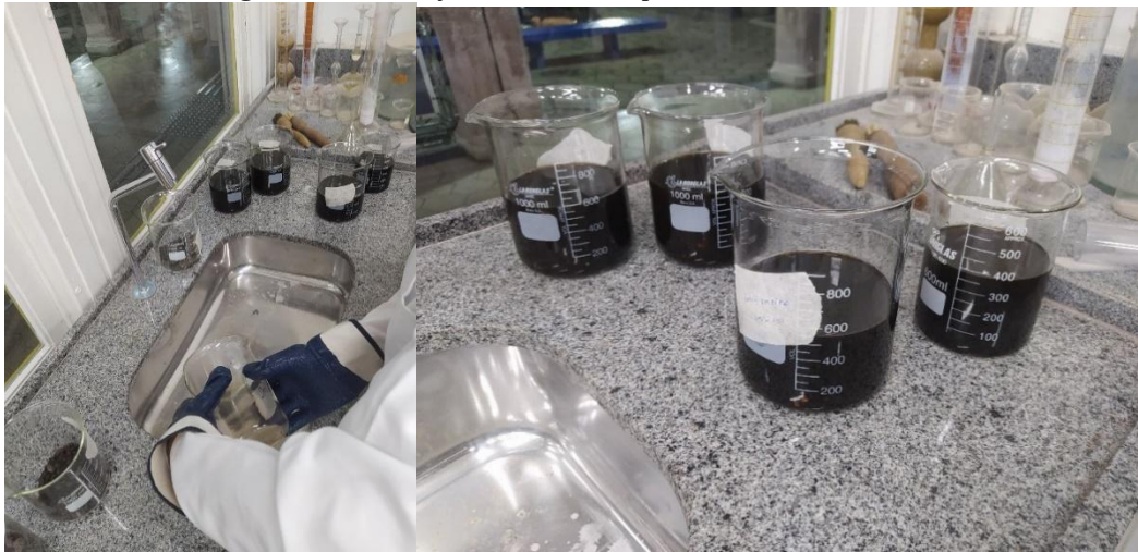
Figuras 1 e 2: Adição de Gasolina tipo A ao material fresado.
